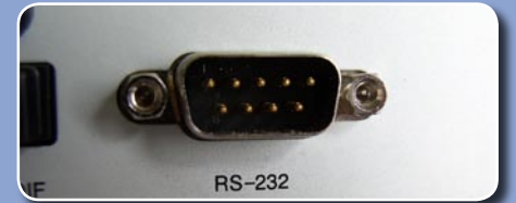
Bilgisayar bağlantısı için çoğu uydu alıcıda bulunan RS-232
