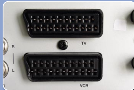
Avrupa uydu alıcılarında ortak bir özellik: TV ve VCR için SCART
