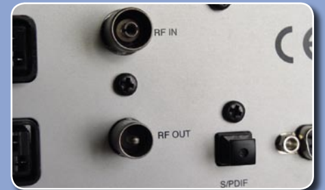
UHF bağlantıları (sol tarafta) Günümüzde nadir rastlanıyor, S/SPDIF girişi ise daha yaygın
