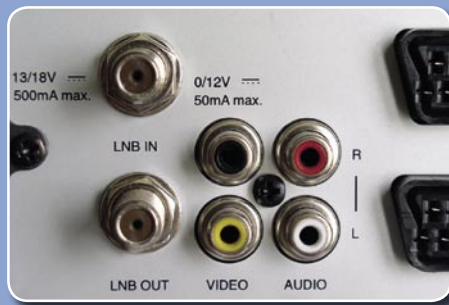
LNB ve Ses çıkışları için standart bağlantılar
